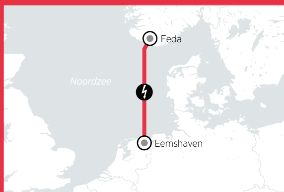
NorNed kabel tussen Eemshaven en Feda, Noorwegen
